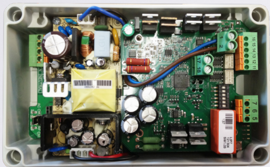
Flex1 ACDC som forsyning til indbygget overlastbeskyttelse, f.eks. LIP7 OC #121308 Boks str. (LxBxH): 180 x 110 x 63 mm
