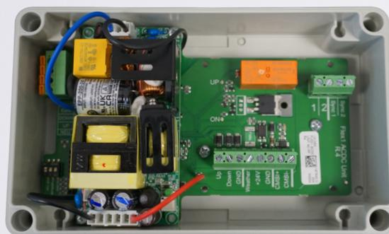
*Flex1 ACDC , alimentation directe pour moteur avec propre protection contre les surcharge.*
