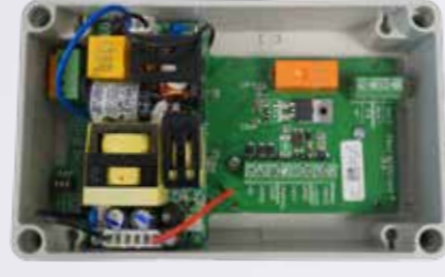
Flex1 ACDC als Versorgung für Motoren mit eigenem Überlastschutz (Ketten- und Zahnstange Motoren), Kastengröße (LxBxH): 180 x 110 x 63 mm
