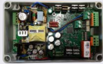
Flex1 ACDC als Versorgung für eingebauten Überlastungsschutz, z.B. LIP7 OC #121308, Kastengröße (LxBxH): 180 x 110 x 63 mm
