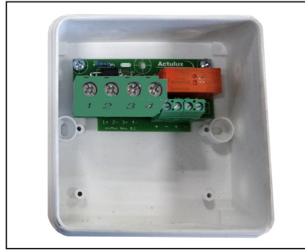
#121031 UniMon 24V L K2 scatola (105,6x105,6x48,5 mm) Morsetti: 10 mm 2
