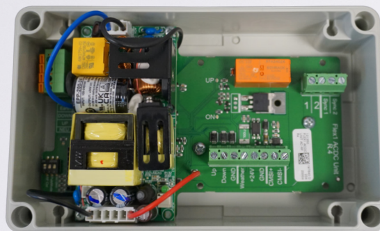
Flex1 ACDC come alimentatore per motori con proprio sistema di fine corsa (attuatori a catena e a cremagliera). Dimensioni scatola (LxPxH): 180 x 110 x 63 mm
