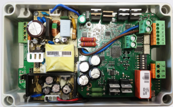
Flex1 ACDC come alimentatore e fine corsa elettronico da sovraccarico: LIP7 OC #121308 Dimensioni scatola (LxPxH): 180 x 110 x 63 mm
